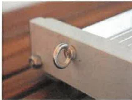
Die Gangway wird ständig von salziger Luft beeinflusst. Um Korrosion vorzubeugen, sollten die Edelstahlteile nicht die Alutelle berühren
