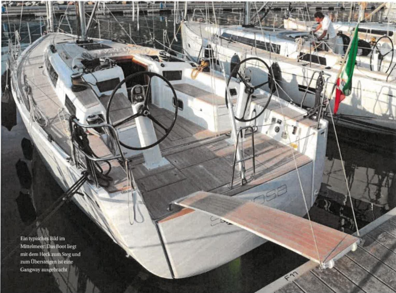
Ein typisches Bild im Mittelmeer: Das Boot liegt mit dem Heck zum Steg und zum Übersteigen ist eine Gangway ausgebracht
